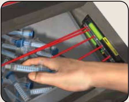
O PVD Orienta o Operador na Montagem de um Conjunto
