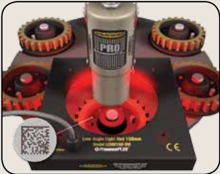
A Ring Light de Baixo Ângulo LEDRI Destaca Códigos de Barra Dot-Peened 2D para Verificação
