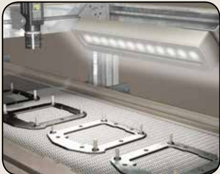
A Luz Linear LEDWLA Mostra Defeitos no Conjunto de Solda
